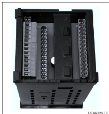
左： Liquisys S CUM 223 在仪表后部的接线端子 右： Liquisys S CUM 223 仪表后部的可更换电子部件 (E)
